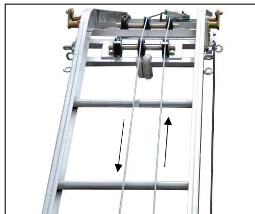
Fig. 37 Kabelgeleiding over het knikstuk
